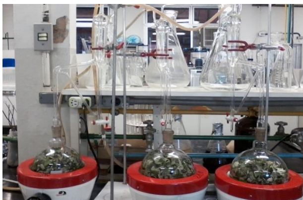
Figura 4 - Aparelhos de Clevenger utilizados para a extração do óleo essencial das folhas da B. laevifolia .
