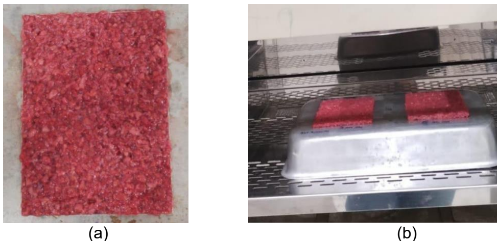
Figura 4 – Matéria-prima preparada (a) para secagem convectiva em estufa (b).
