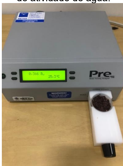
Figura 9 – Pulmão suíno moído seco por cast-tape drying sendo submetido a análise de atividade de água.
