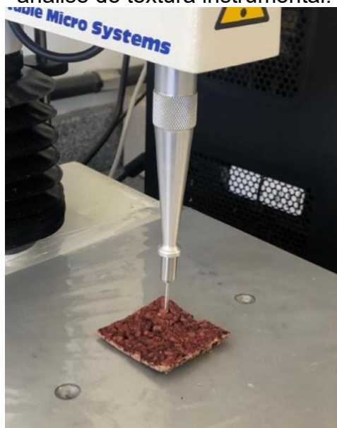
Figura 8 – Pulmão suíno moído seco em estufa convectiva sendo submetido a análise de textura instrumental.
