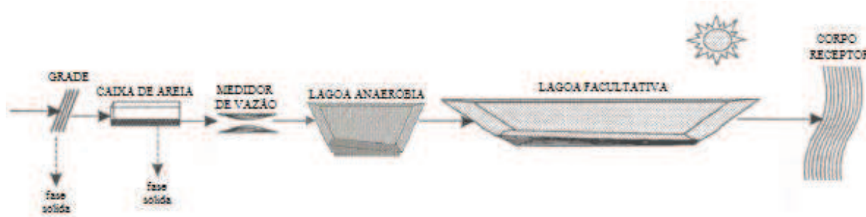
Figura 18 – Sistema com lagoa anaeróbia seguida por lagoa facultativa
