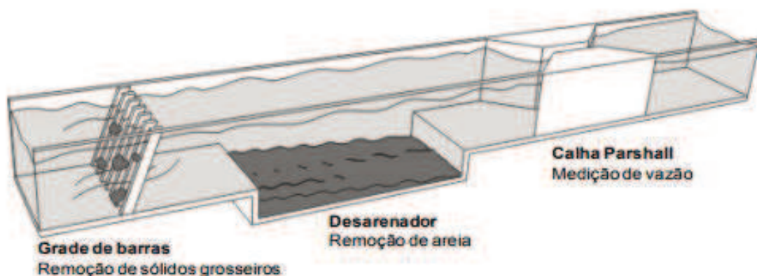
Figura 4 – Fluxograma típico do tratamento preliminar
