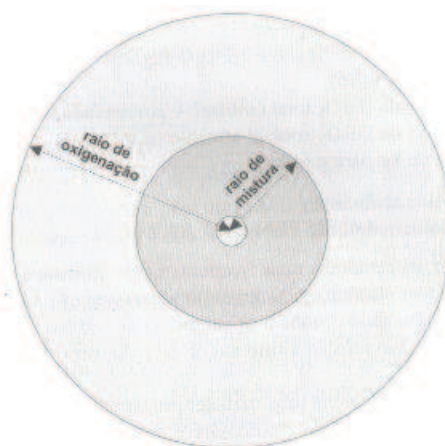
Figura 20 - Raios de mistura e oxigenação para aeradores superficiais mecânicos
