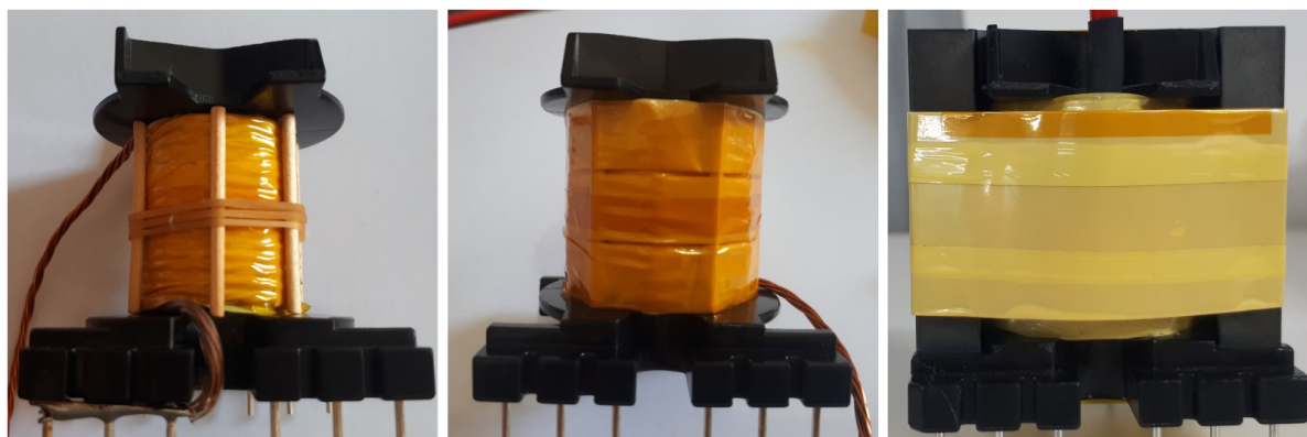
Figura 72 – Método de construção do indutor do Boost - LBoost.
