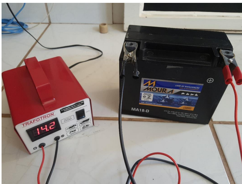
Figura 46. Método de carregamento das baterias.
