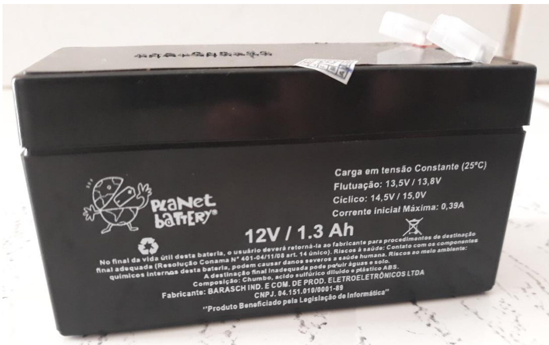
Figura 42. Bateria de 12V e 1,3 Ah, utilizada no primeiro teste.
