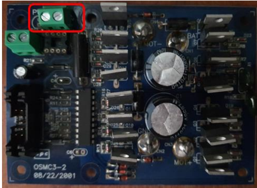
Figura 43. Placa OSMC com indicação do terminal onde foi ligada a bateria no primeiro teste.
