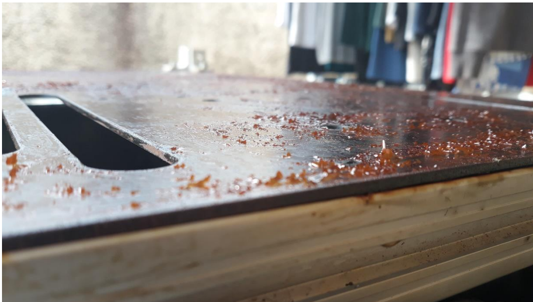
Figura 33. Superfície do assoalho após aplicação do gel para remoção de oxidação.
