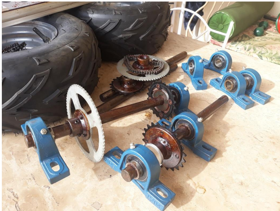
Figura 32. Eixos e engrenagens após aplicação do gel para remoção de oxidação
