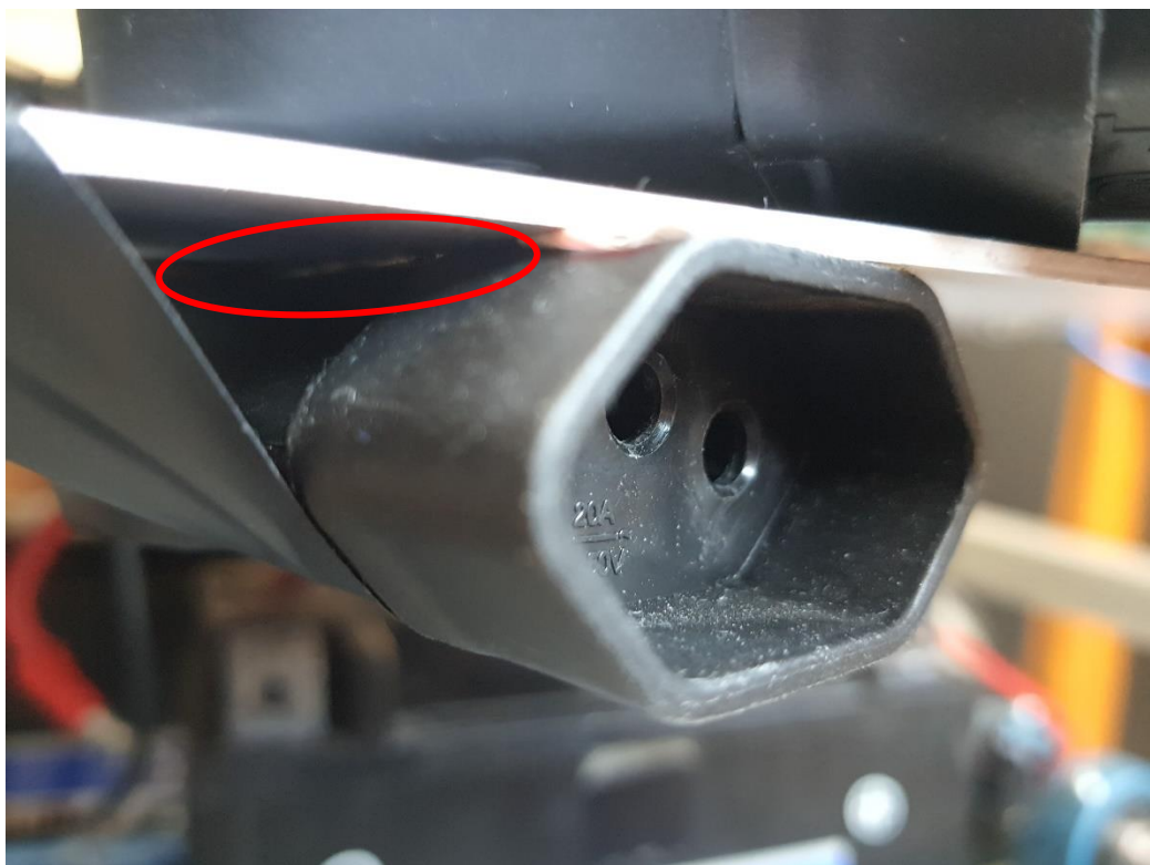
Figura 41. Fixação do plug fêmea tipo N por baixo do mezanino com fita dupla face e fita isolante.
