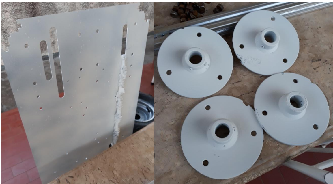
Figura 35. Assoalho e cubos de roda após aplicação do fundo antioxidante
