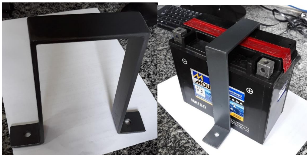
Figura 24. Abraçadeira de aço, para retenção das baterias na direção vertical.
