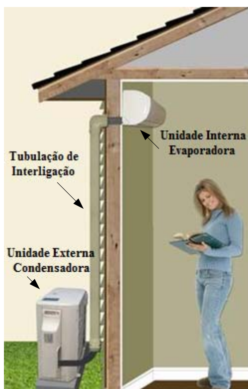
Figura 2.10 – Aparelho condicionador de ar Split instalado em uma residência.
