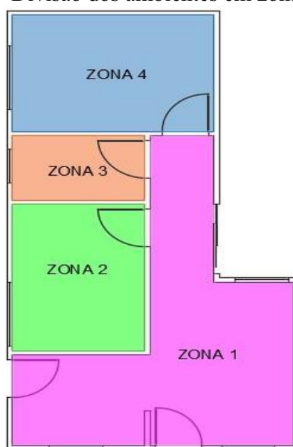
Figura 14 - Divisão dos ambientes em zonas térmicas
