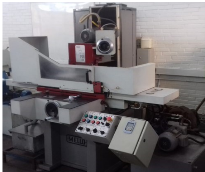
Figura 8 - Retificadora Plana Tangencial P36, Mello, utilizada nos ensaios.
