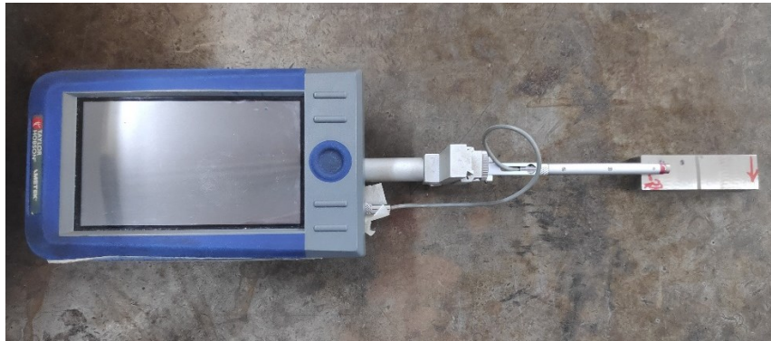
Figura 13 - Rugosímetro portátil utilizado e os pontos de amostragem.
