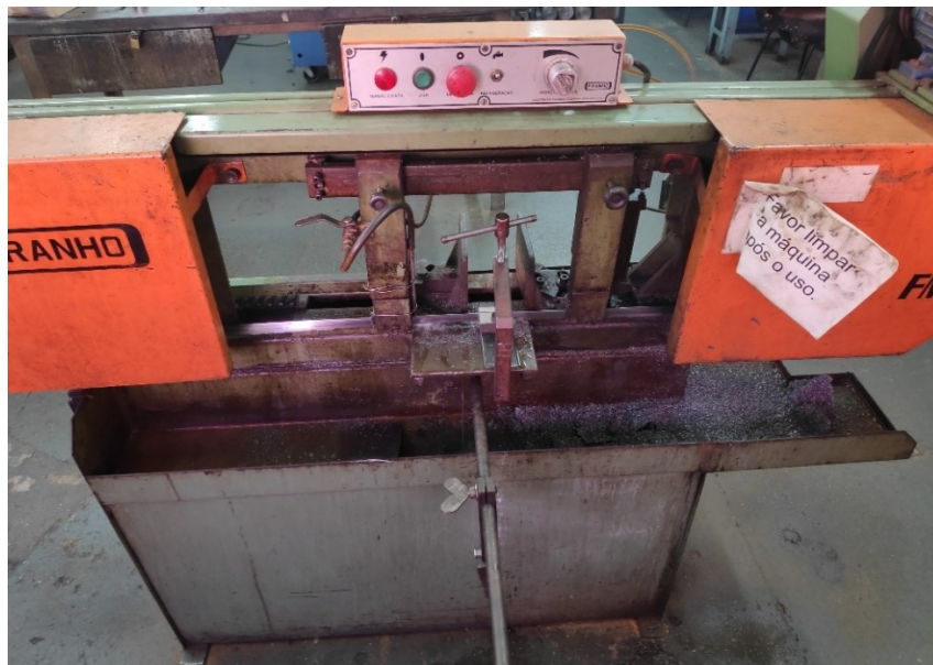
Figura 10 - Máquina serra-fita usada para cortar as amostras de aço inoxidável ABNT 316 M.
