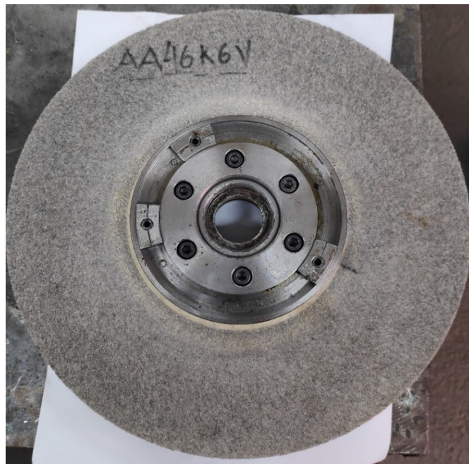
Figura 9 - Rebolo de óxido de alumínio branco utilizado no ensaio.
