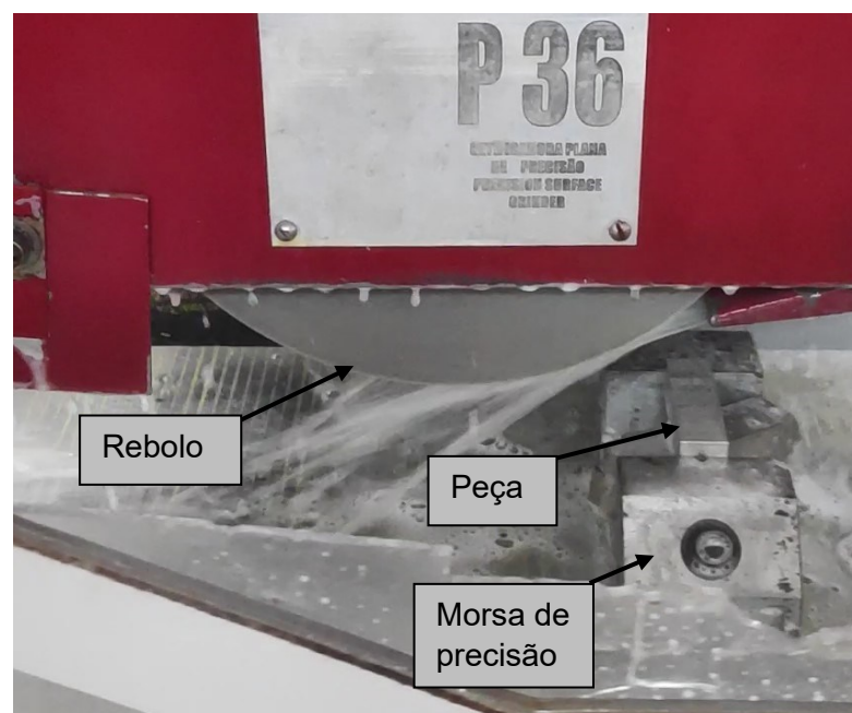
Figura 12 – Sistema de montagem da peça na morsa sobre a mesa da retificadora.
