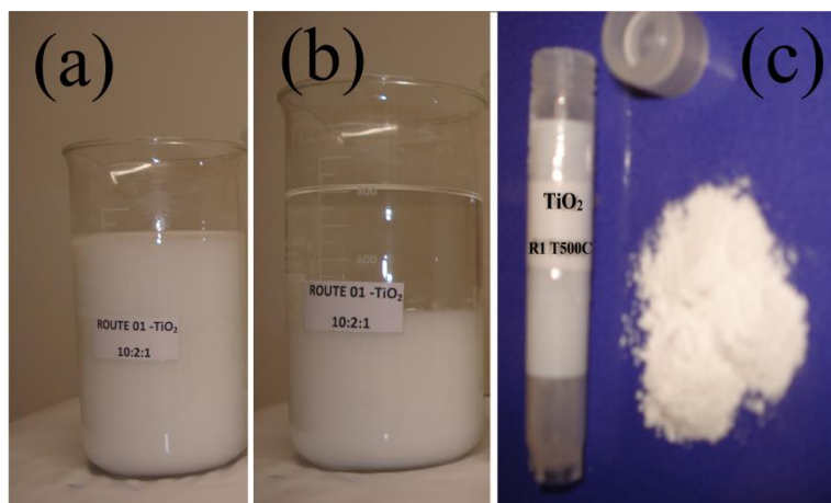
Figura 1 – Fases após a síntese de nanocristais de \text{TiO}_2 : (a) solução obtida após a síntese; (b) solução em repouso (precipitada); (c) nanocristais em pó, obtidos após ciclos de aquecimento contínuos até 500^\circ\text{C} .
