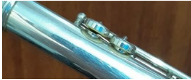
Figura 36 - Chave com vazamento devido à mola fora do lugar.
