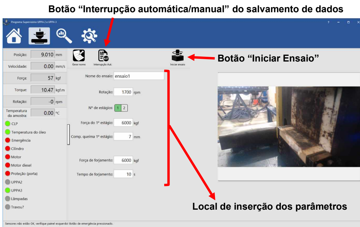
Figura 34: Sub-rotina “Ensaio” do programa SUPPA32, onde o usuário informa os parâmetros de ensaio.
