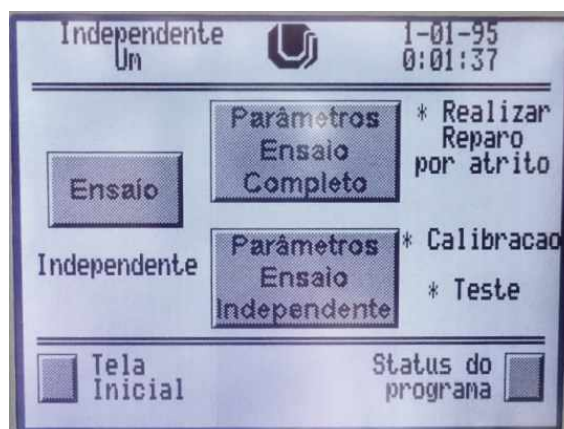
Figura 20: Interface Homem Máquina (IHM) utilizada para configuração de parâmetros de ensaio (BORGES, 2011).
