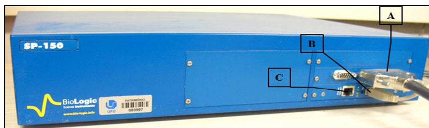
Figura 3.2. Potenciostato BioLogic SP150. (A) Saída de sinal potencial e aquisição de sinal de corrente da célula eletroquímica; (B) Saída de dados para processamento no “software” por porta USB; (C) Saída de dados para processamento no “software” por porta Ethernet.
