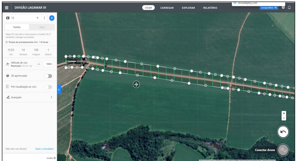
Figura 8 – exemplo de plano de voo utilizado (interface do aplicativo Drone Deploy).
