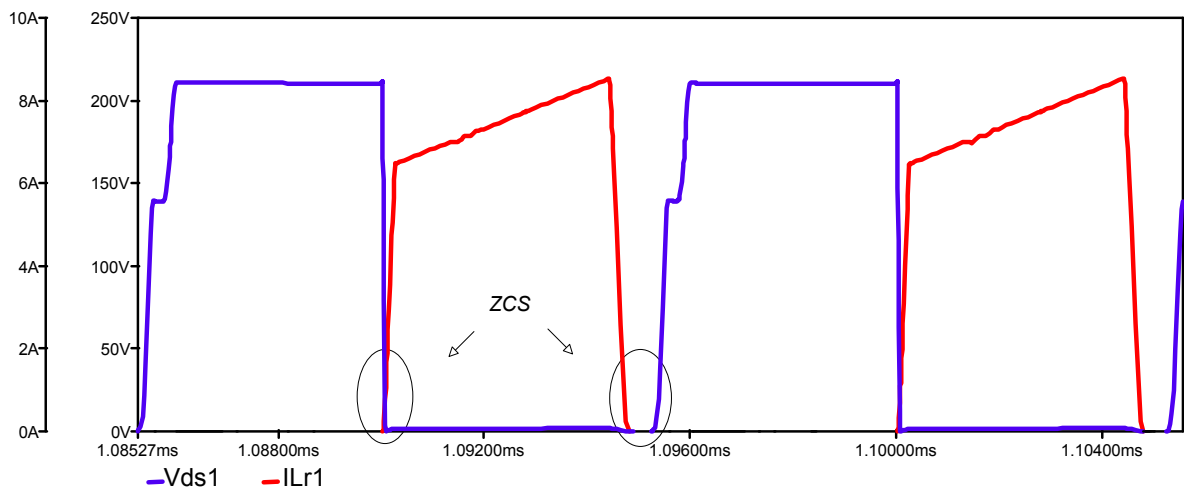
Figura 6. 2 – Gráfico da tensão ( V_{ds1} ) e corrente ( i_{Lr1} ) na chave S_1 .
