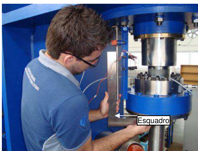
Figura 4.15 – Ajuste do alinhamento do LVDT utilizando um esquadro.
