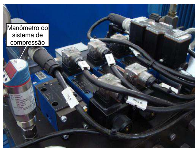
Figura 4.20 – Bloco de válvulas da unidade hidráulica mostrando o manômetro digital do sistema de compressão e válvulas do Tribômetro.
