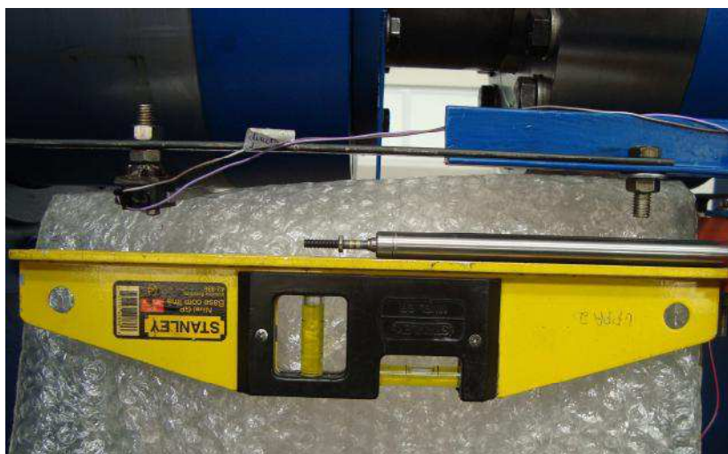
Figura 4.7 – Verificação do alinhamento do LVDT utilizando nível de bolha.
