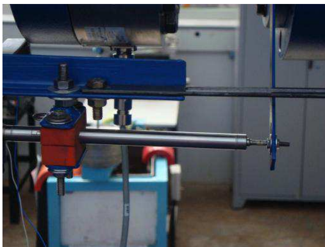
Figura 3.8 – Suportes de fixação dos LVDTs.
