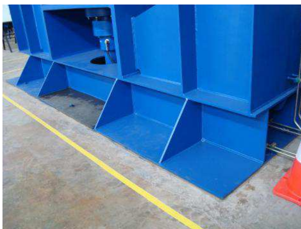
Figura 3.16 – Base de instalação do Tribômetro.
