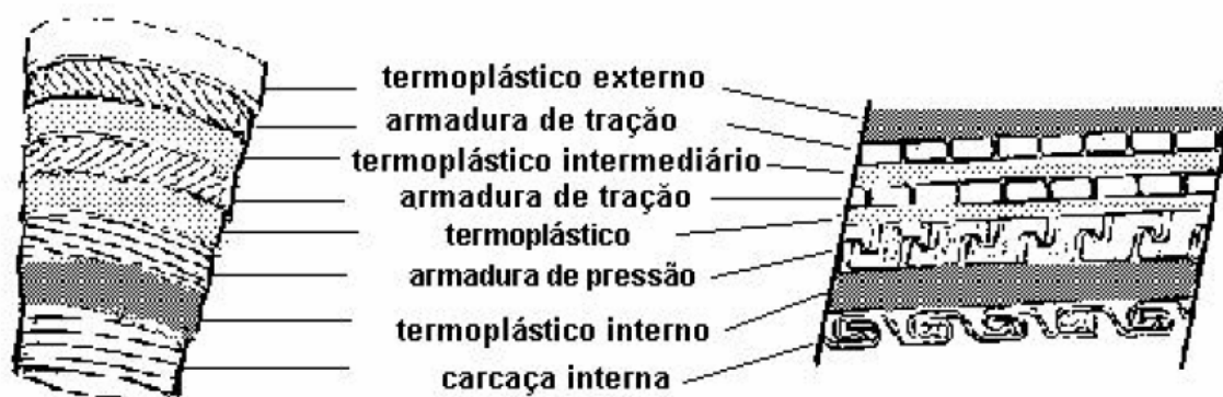
Figura 1.2 – Estrutura de um duto flexível (CHEN, 1995).
