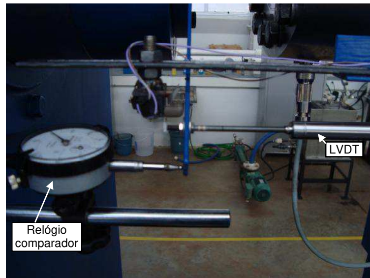
Figura 4.12 – Detalhes do posicionamento do relógio comparador para verificação do LVDT do lado direito.
