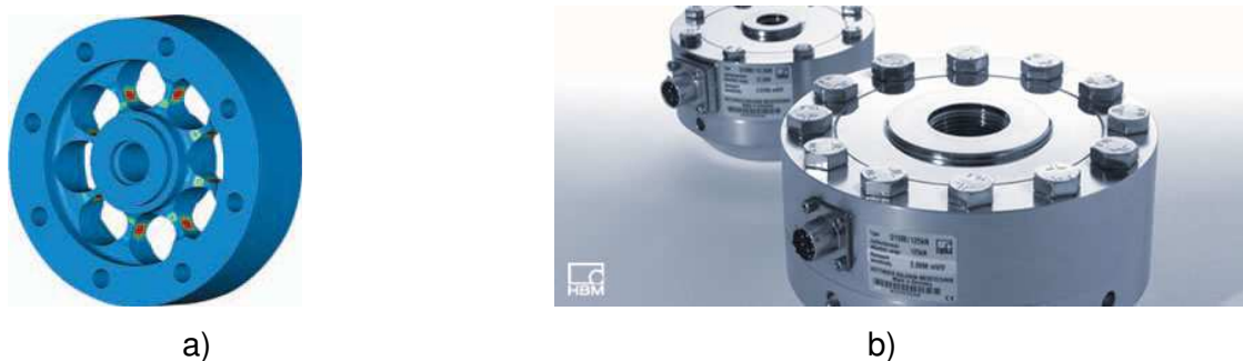
Figura 3.4 – Célula de carga utilizada no Tribômetro: a) Construção interna da U10 M; b) Foto da célula de carga (HBM - Data Sheet Force Transducers U10 M).
