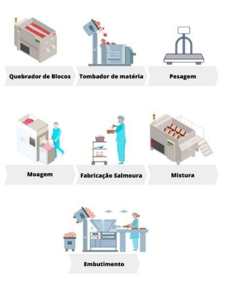
Figura 6 - Processo produtivo interno da Massa de linguiça fresca.
