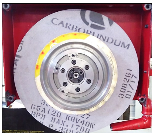
Figura 3. 3 - Posicionamento dos rebolos de alumina na máquina retificadora plana tangencial a) monocristalina (65A120K8V40W) e (b) branca convencional (AA120K8V40W).
