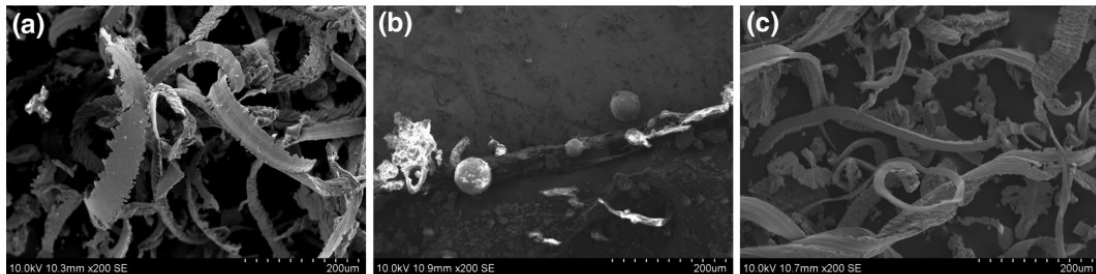
Figura 2. 14 - Cavacos obtidos nas condições a seco (a), com fluido de corte (b) e criogênica (c) após a retificação do aço endurecido AISI D3 (MANIMARAN et al., 2015).
