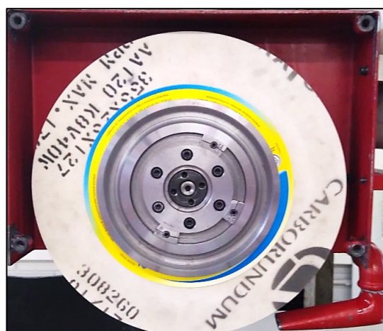
Figura 3. 3 - Posicionamento dos rebolos de alumina na máquina retificadora plana tangencial a) monocristalina (65A120K8V40W) e (b) branca convencional (AA120K8V40W).
