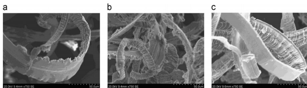
Figura 2. 13 - Cavacos formados nas condições a seco (a), com fluido de corte (b) e criogênica (MANIMARAN; KUMAR, 2013).
