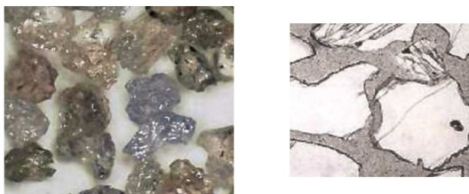
Figura 2. 22 - Partículas abrasivas de alumina branca (a) e de alumina monocristalina (b) (SAINT GOBAIN, 2017).
