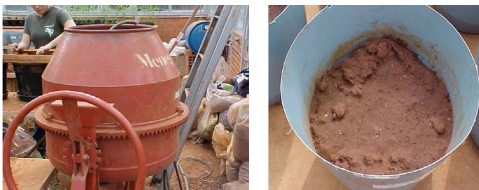
FIGURA 12 – Betoneira utilizada para mistura dos materiais e solo incubado por 15 dias.
