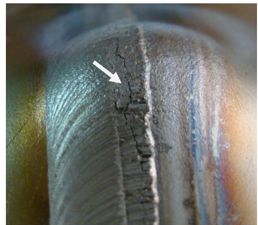
Figura 6.42. Ensaio de embutimento realizado na face do corpo de prova de metal de base AISI 441, soldado com o metal de adição ER430LNb e com o gás de proteção Ar+2%O 2 (a) gráfico da força em função do deslocamento do punção e (b) aspecto visual do corpo de prova ensaiado
