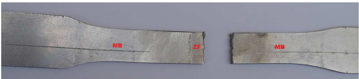
Figura 6.3. Ensaio de tração onde o rompimento ocorreu na zona de ligação
