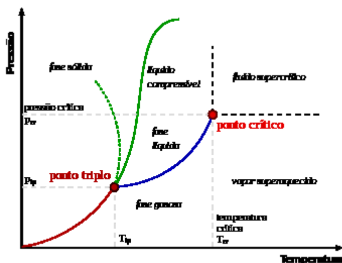
Figura 11: Diagrama representativo de fases Pressão e Temperatura
