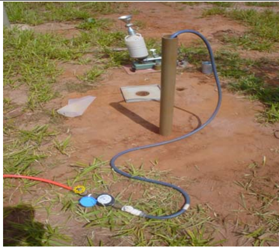
FIGURA 3.55: Ensaio de permeabilidade realizado em furo de trado, em execução.
