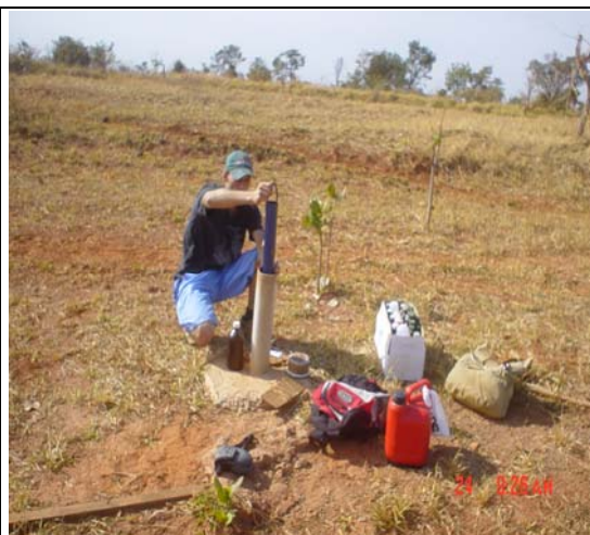
FIGURA 3.51: Coleta de amostra de água do Poço 1 – a montante do aterro. FONTE: FINOTI, Diogo, 2005.
