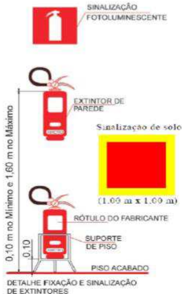
Figura 90 - Indicação de proteção contra incêndios
