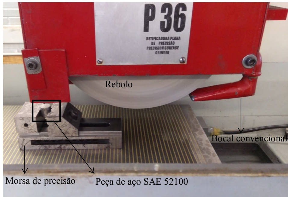
Figura 3.5 - Posicionamento da peça de aço SAE 52100 em uma morsa de precisão sobre a mesa magnética da máquina-ferramenta.
