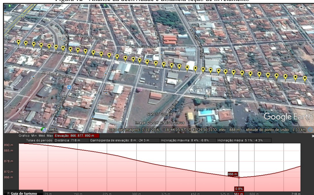
Figura 12 - Análise da declividade e distância seção de nivelamento
