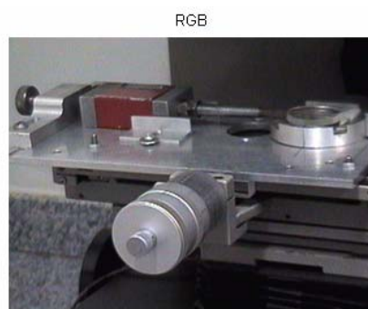
Figura 6.6b – Detalhe do dispositivo de compressão diametral posicionado no modelo fotoelástico
