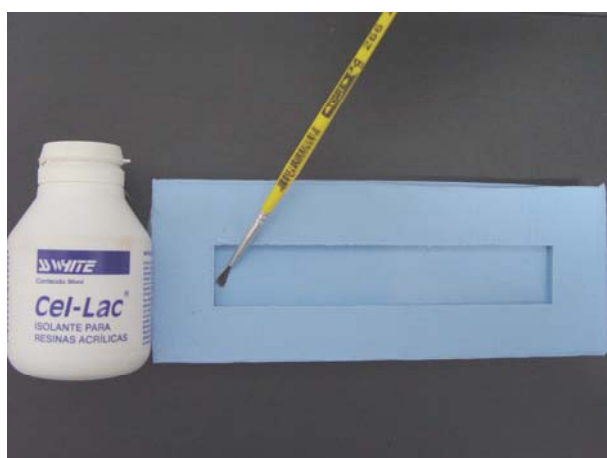
Figura 6.3 – Isolante utilizado para facilitar a desmontagem dos corpos de prova.
