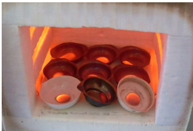
Figura 7.9 – Amostras de carvão no forno a 900^\circ\text{C} para a determinação do teor de cinzas
