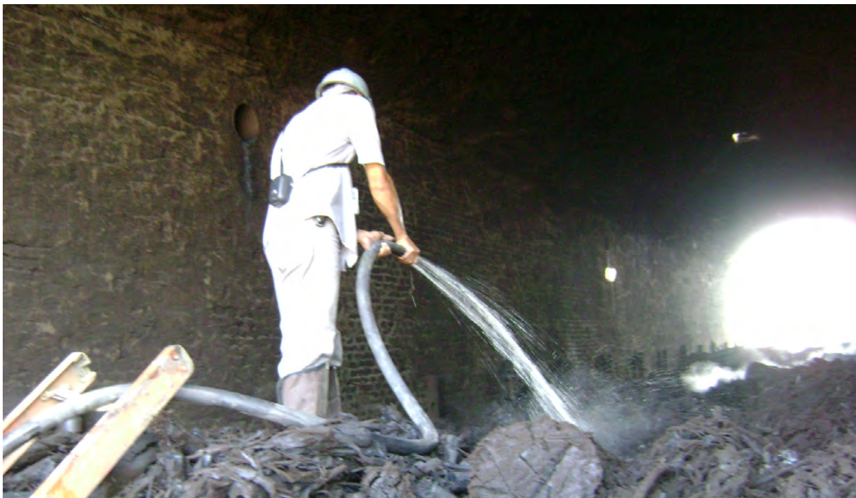
Figura 7.2 – Combate de focos de fogo dentro de um forno recém aberto
