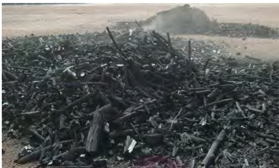
Figura 5.13 - Carvão produzido em um forno adaptado em combustão espontânea
