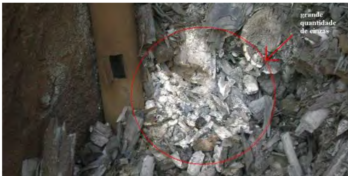
Figura 5.11 – Focos de fogo dentro de um dos fornos adaptados com o sistema de gaseificador
