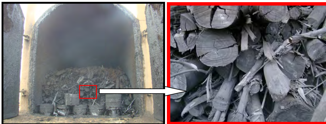
Figura 4.19 – Tiços na região próxima a uma das portas
