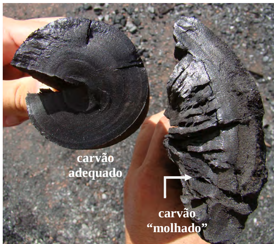
Figura 7.3 – Diferença entre um carvão que recebeu água dentro do forno e um carvão produzido de forma adequada
