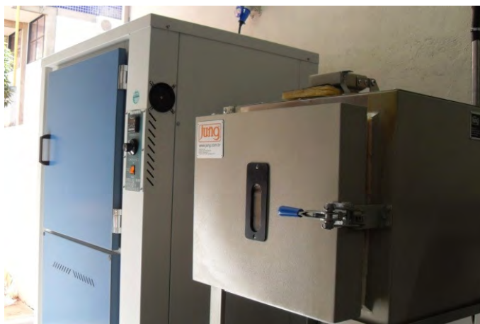
Figura 7.7 – Estufa à esquerda utilizada para determinar o teor de umidade. Mufla à direita para testes de voláteis e cinzas
