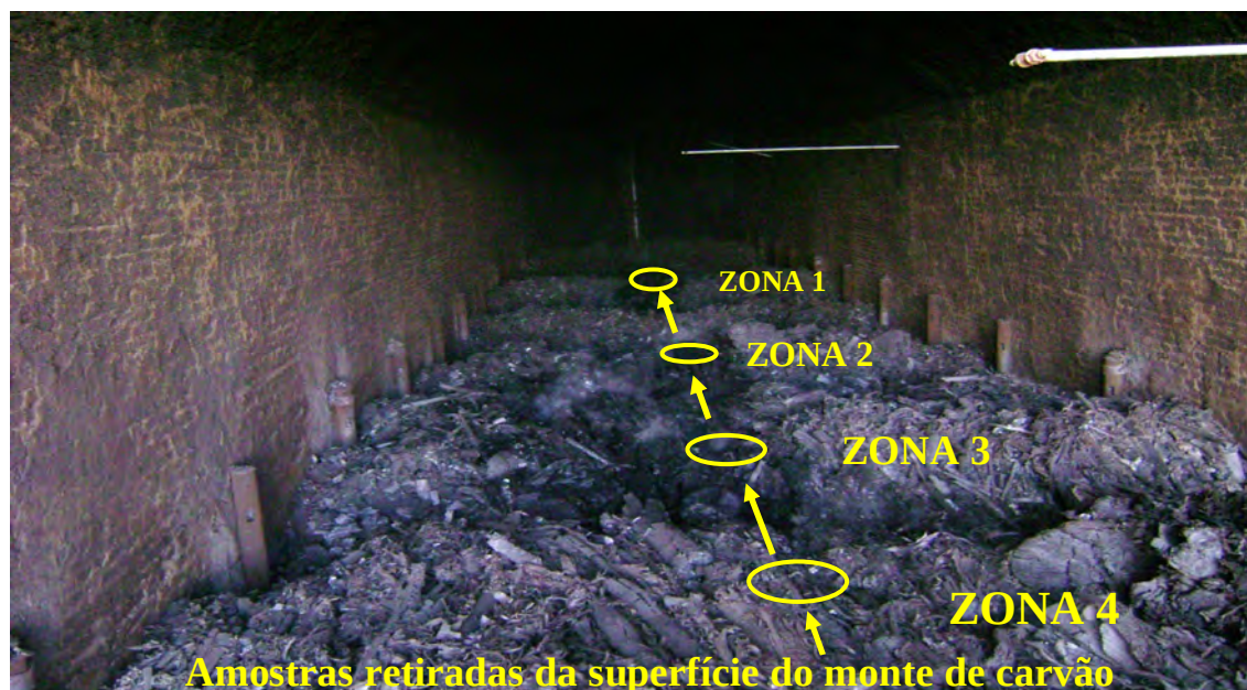
Figura 7.4 – Metodologia de coleta de amostras de carvão de um monte no interior do forno
