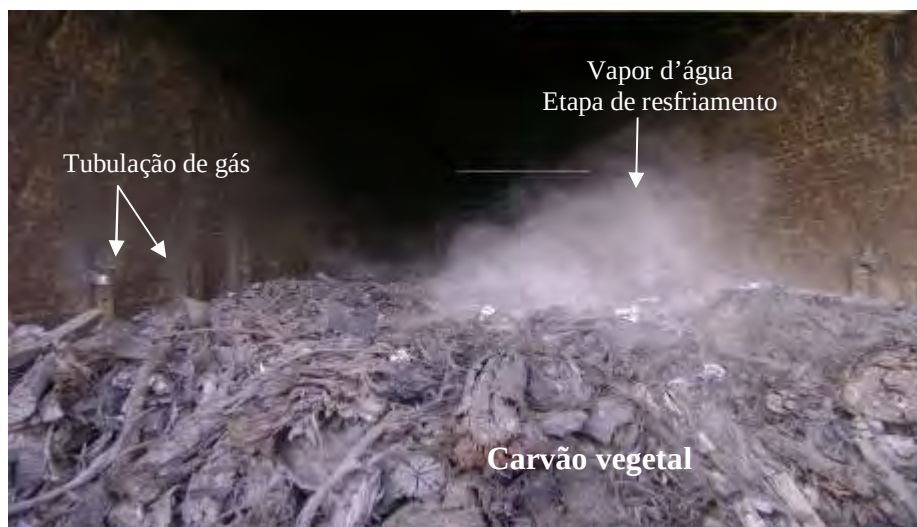
Figura 5.12 - Abertura de um dos fornos adaptados – nuvem de vapor d'água
