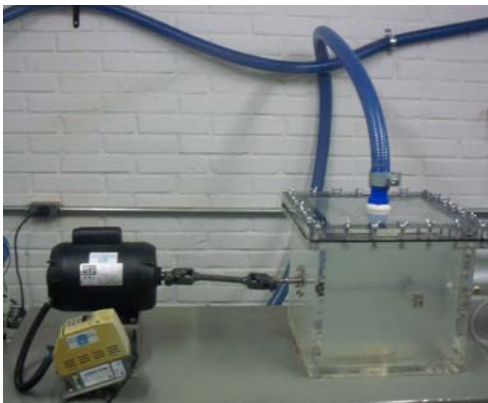
(a) Caixa de alimentação e motor para rotação do eixo interno
