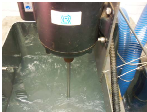
Figura 6.5: Homogeneização da solução no tanque e as mangueiras de reciclo e de by-pass .
