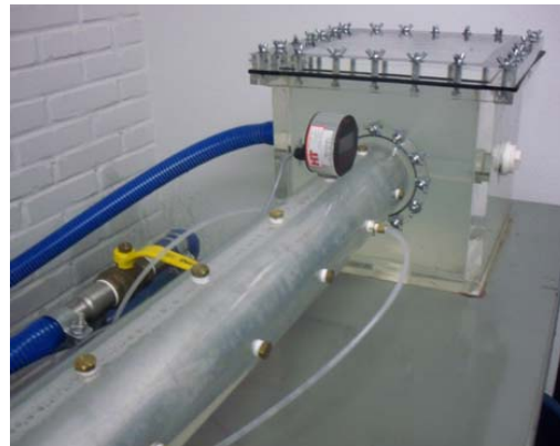
(b) Caixa de saída, válvula e mangueira de reciclo
