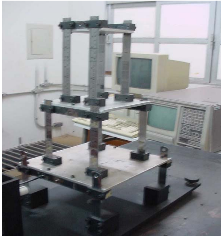
Figura 5.13 – Modelo experimental utilizado para avaliar os métodos de identificação.
