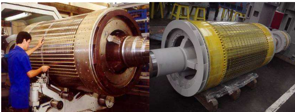
Figura 2.9 - Rotor de pólos lisos Fonte: Apresentação DT-5 WEG
