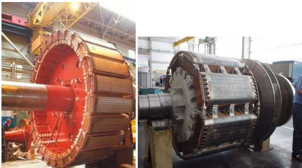
Figura 2.11- Rotores de pólos salientes Fonte: Apresentação DT-5 WEG
