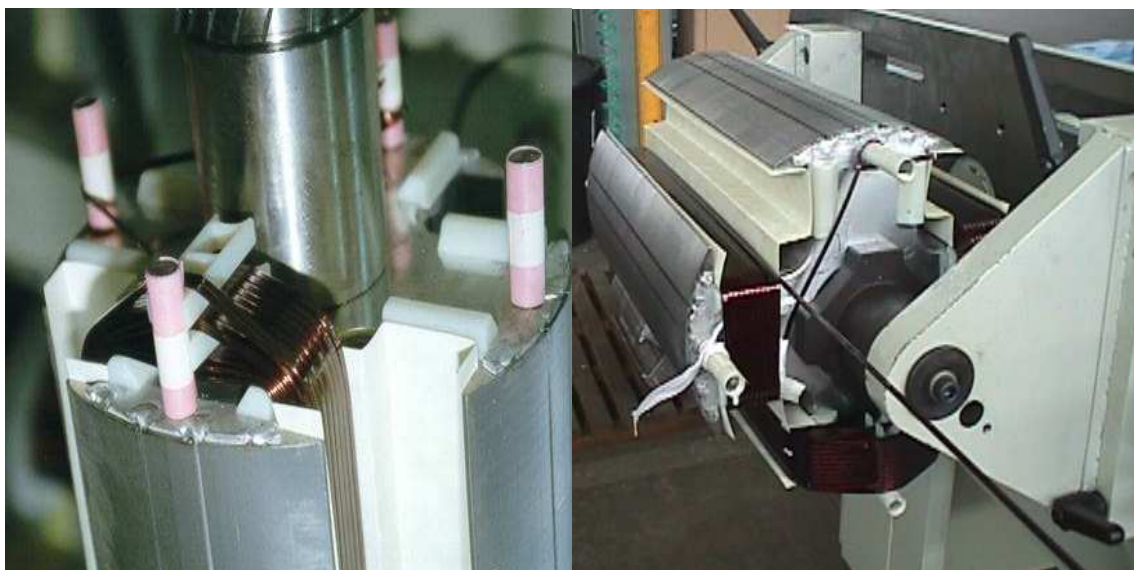
Figura 2.10 Fabricação de um pólo Fonte: Apresentação DT-5 WEG
