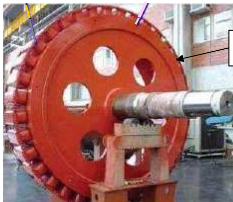
Figura 2.12- Rotor com enrolamento amortecedor [16]
