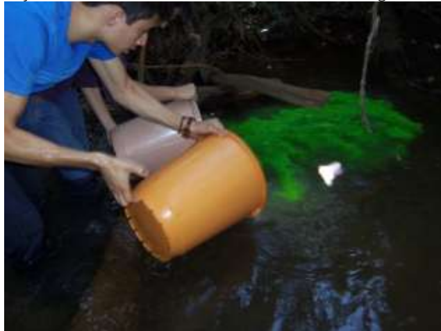
Figura 19 Injeção do traçador salino NaCl concomitantemente com o traçador fluorescente Fluoresceína Sódica no córrego do Meio -
