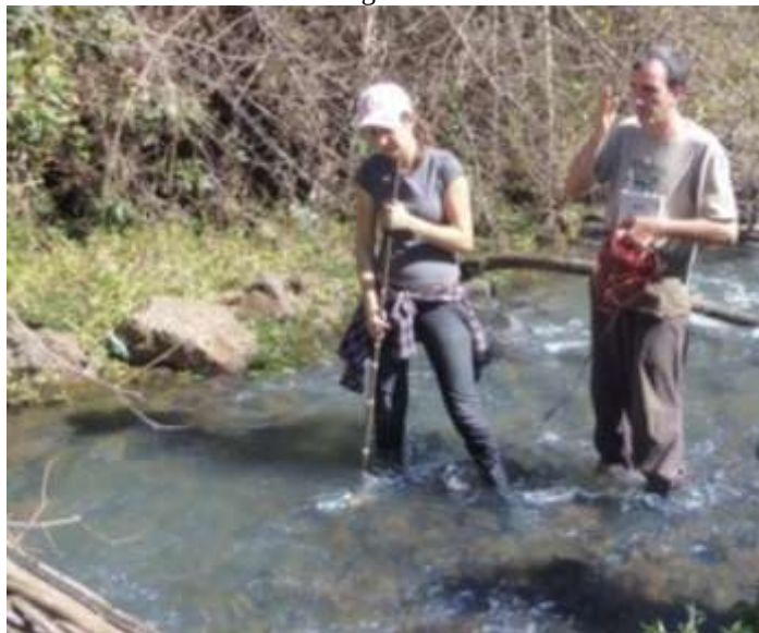
Figura 33 - Medição da velocidade com o método de Molinete Hidrométrico no Córrego do Retiro em 27/07/2012
