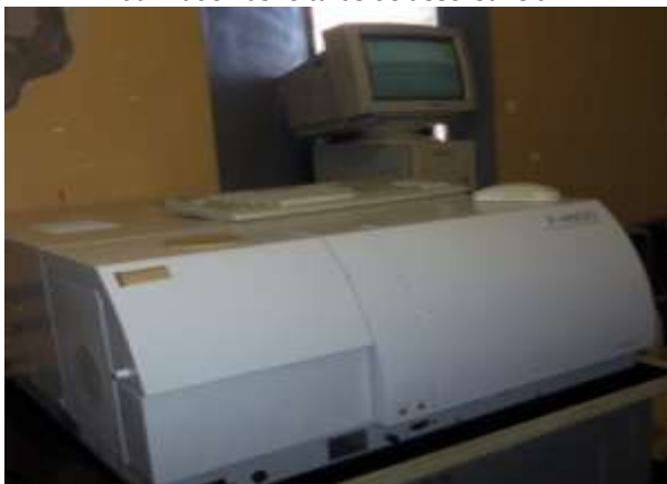
Figura 39- Espectrofluorímetro Hitachi modelo F4500 utilizado nas leituras de absorbância
