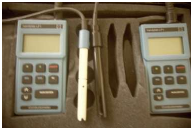
.Figura 43 - Condutivímetros portáteis, marca Schoot , modelo HandyLab LF1 utilizados nas leituras da condutividade.
