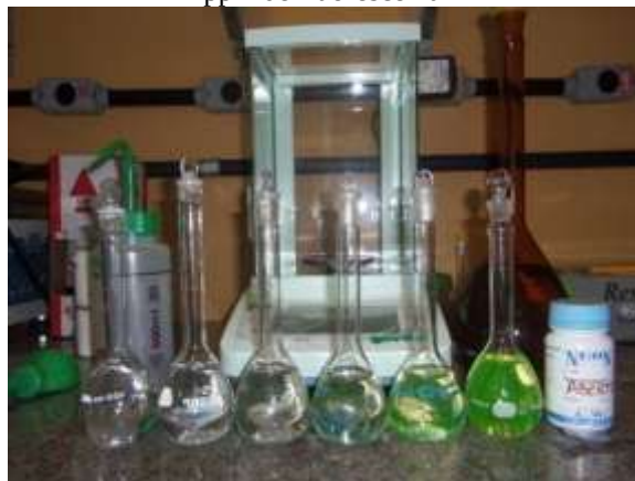
Figura 40- Diluição em série da solução padrão de 5 ppm de fluoresceína
