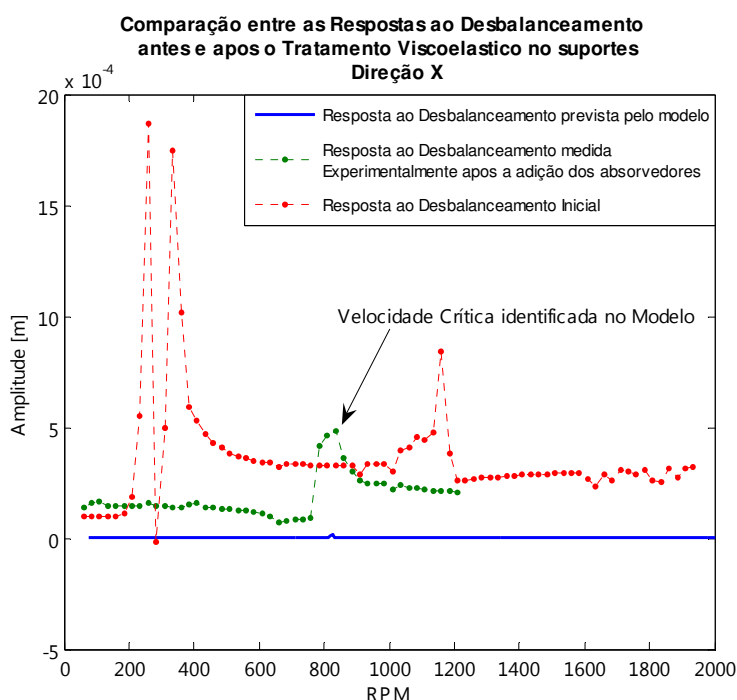
Figura 5.15 – Resposta ao Desbalanceamento medida no Rotor comparada à prevista pelo modelo – Direção X.
