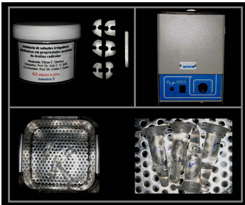
Figura 8 – Amostras imersas na solução irrigadora testada sob agitação em aparelho de ultrassom.
