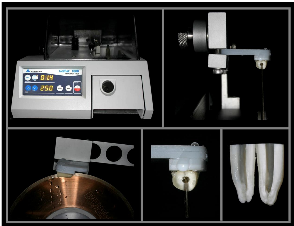
Figura 4 – Preparo das amostras: secção axial da raiz utilizando cortadeira de precisão, obtendo-se duas fatias por raiz.
