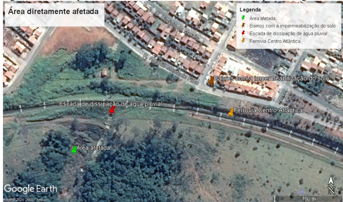
Figura 5 - Início do processo erosivo a jusante a via férrea, no município de Araguari -MG.
