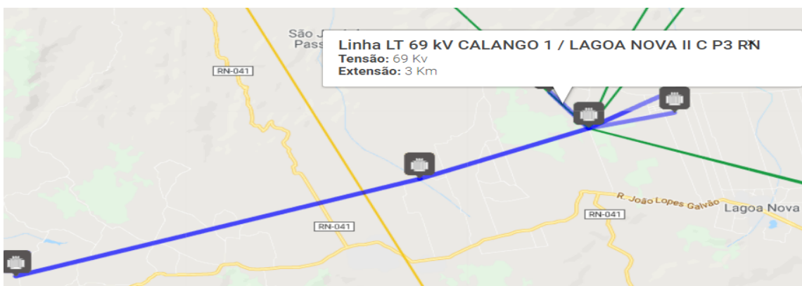
Figura 4 - Linha de transmissão subestações Calango 1 e Lagoa Nova II
