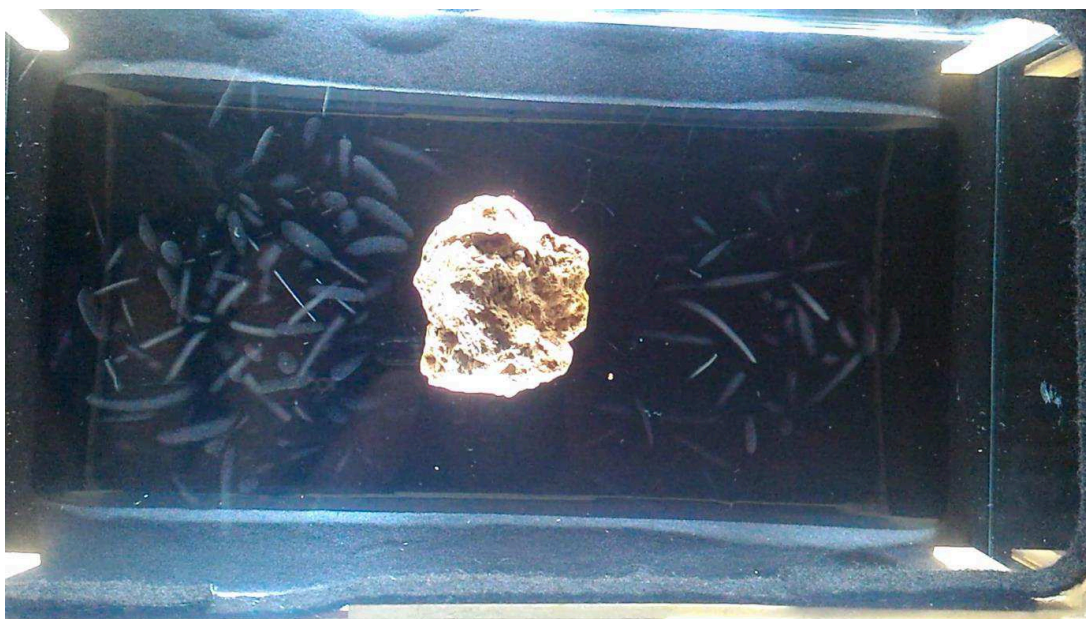
Figura 28: Visão superior das emissões em uma amostra de areia monazítica.
