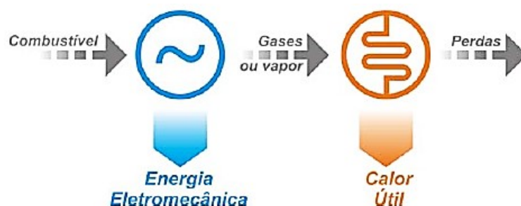
Figura 4 - Cogeração do tipo topping . Fonte: BARJA, 2006.
