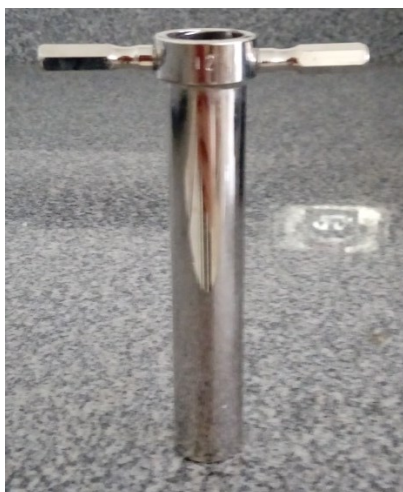
Figura 3 - Cortador cilíndrico do abacaxi.
