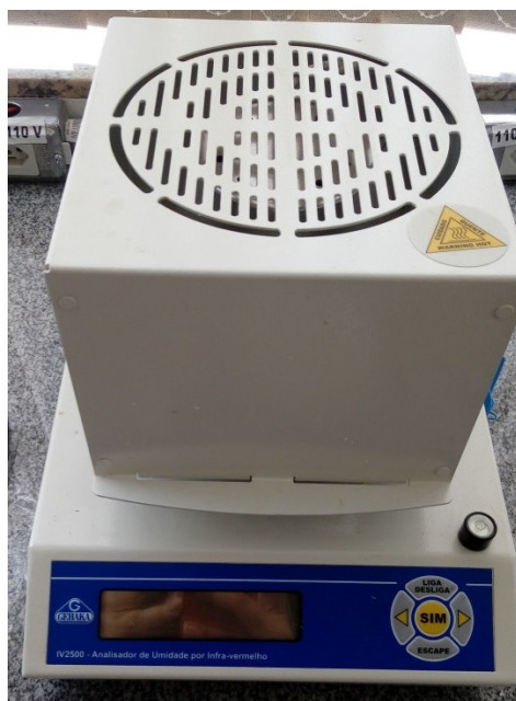
Figura 5 - Analisador de Umidade por infravermelha (IV 2500, GEHAKA).
