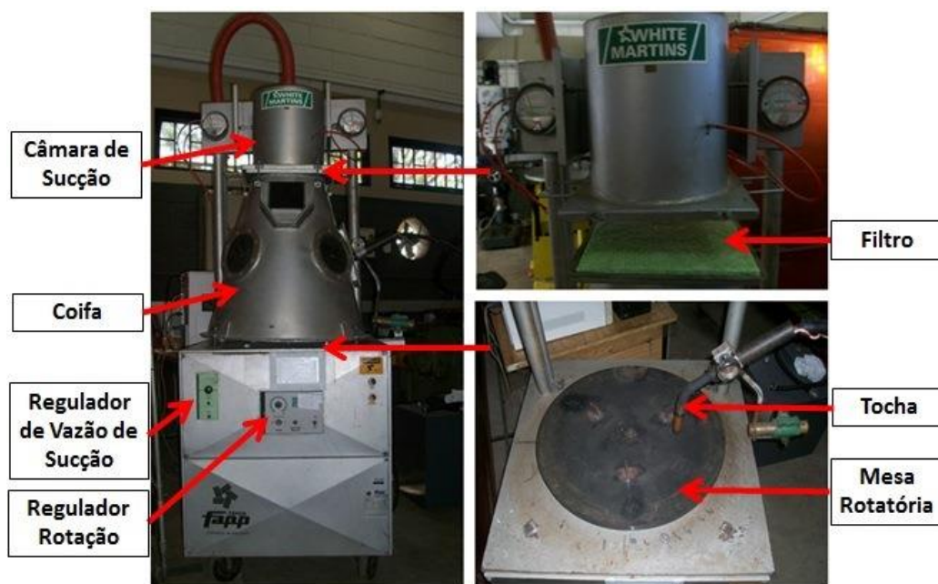
Figura 3.2 – Coletor de fumos de soldagem do Laprosolda/UFU, com detalhes da mesa rotatória e do suporte para colocação do filtro coletor de fumos
