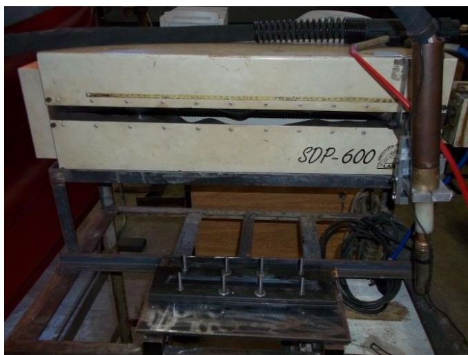
Figura 3.22 - Equipamento SDP-600 utilizado nas soldagens das placas de testes durante a parametrização
