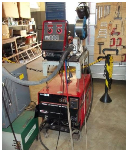
Figura 3.1 - Equipamento usado para soldagens MIG/MAG convencionais (Lincoln Power Wave 455 STT)
