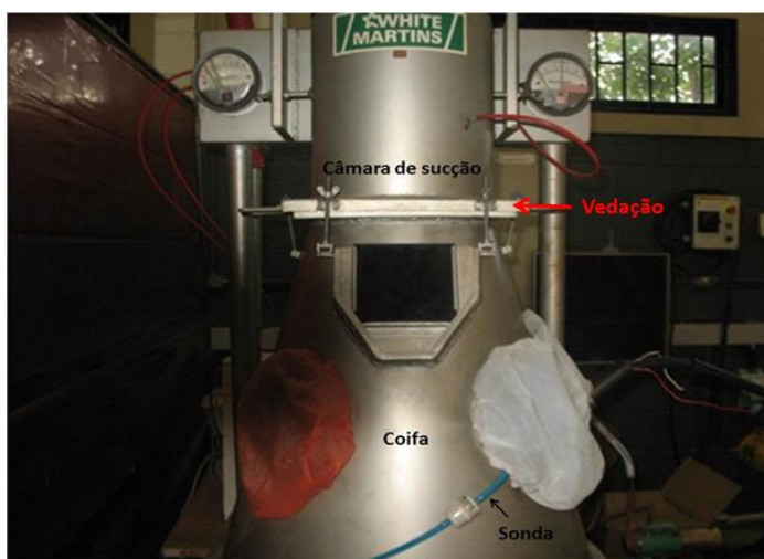
Figura 6.25 – Vista da montagem do coletor de fumos adaptado para medição dos gases CO e CO 2 residuais
