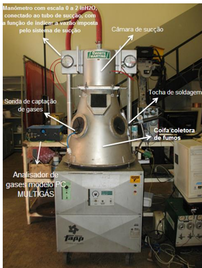
Figura 3.9 – Vista da montagem do coletor de fumos adaptada para medição de emissão de gases
