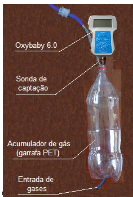
Figura 3.7 – Dispositivo utilizado para garantir a mistura dos gases para as medições durante a aferição do PC-MULTIGÁS
