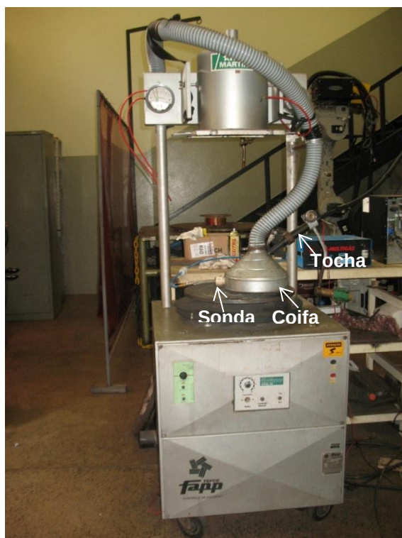
Figura 3.12 - Detalhe da posição de montagem da sonda de captação de gases
