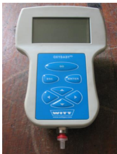
Figura 3.6 - Analisador de gases modelo Oxybaby 6.0 - O_2/CO_2 , marca WITT-GASETECHNIK GmbH&Co KG
