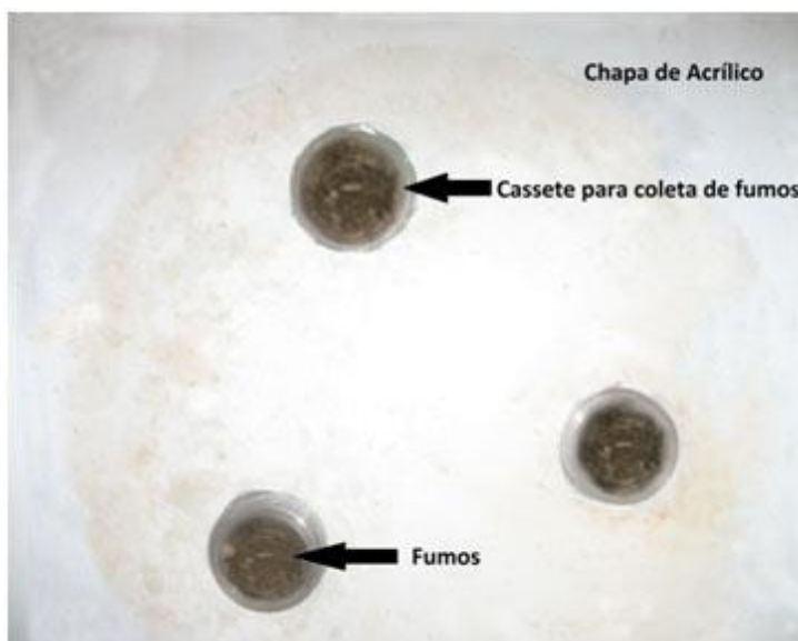
Figura 3.21 - Coletores de fumos sobre a chapa de acrílico após a soldagem
