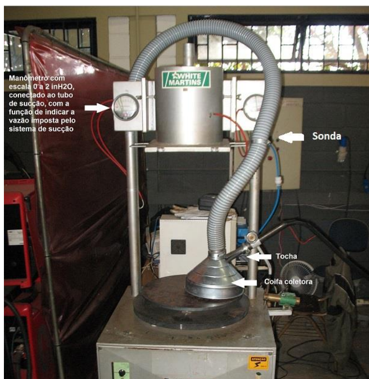
Figura 3.10 – Montagem da coifa especial coletora de gases no equipamento para medição de emissão de fumos
