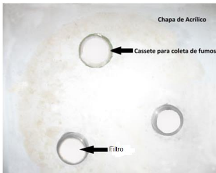
Figura 3.20 - Coletores de fumos adaptados sobre a chapa de acrílico antes das soldagens
