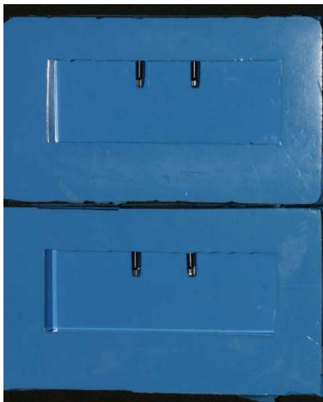
Figura 28 – Modelos fotoelásticos polimerizados dentro de seus moldes.
