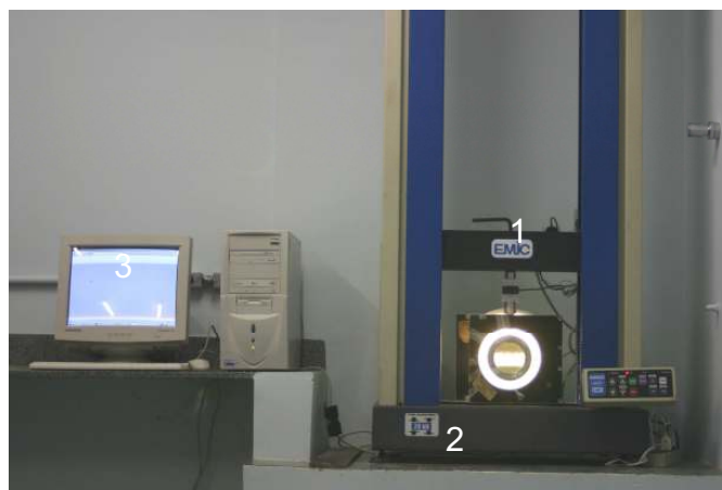
Figura 36 – Máquina de ensaio (1) com o polariscópio (2) posicionado e um computador (3) interligado para a execução dos ensaios.
