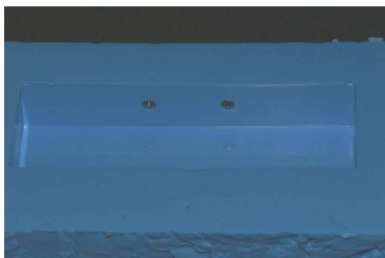
Figura 26 - Molde em silicone com a base mestra.
