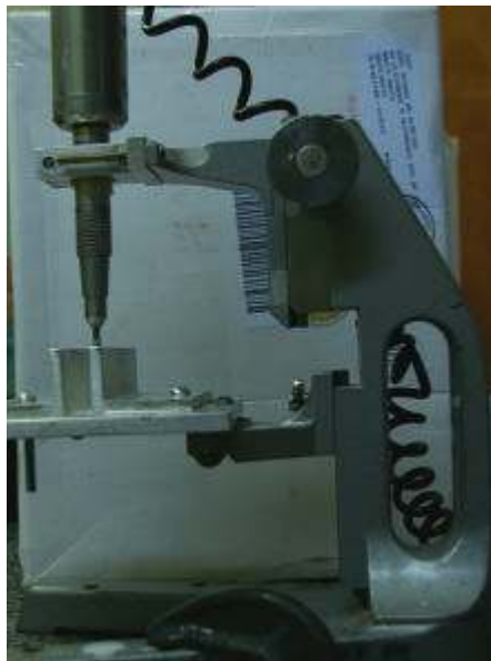
Figura 12 - A – Furadeira de bancada com motor adaptado para perfuração
