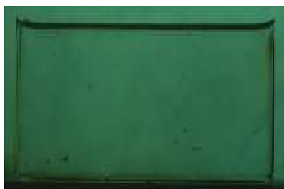
Figura 10 - Modelo fotoelástico livre de tensões visto no polariscópio plano
