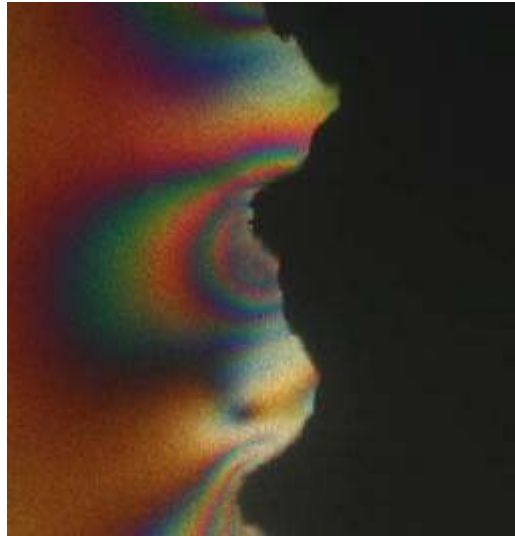
Figura 24 - Imagem das franjas próximo às roscas
