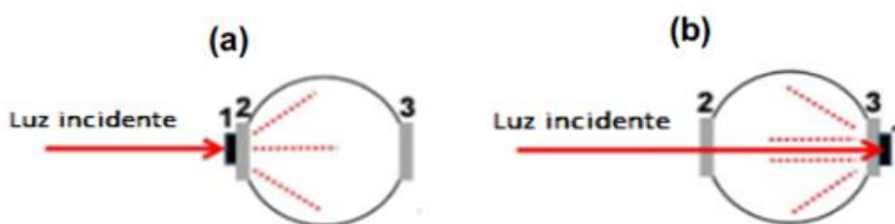
Figura 14 – Esquema de medida de (a) transmissão e (b) reflexão, utilizando (1) a amostra, (2) porta de entrada e (3) porta de saída.
