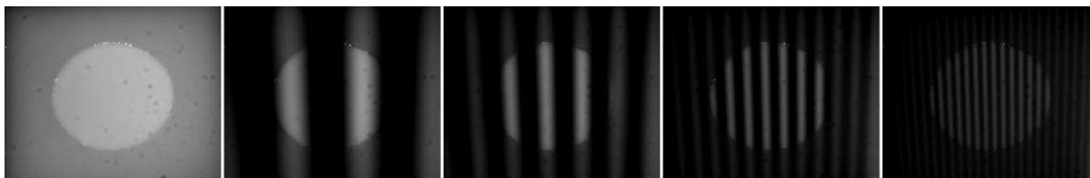
Figura 22 - Imagens moduladas do leite integral obtidas a partir do LabView na fase 0° e na frequência espacial de 0 mm -1 ; 0,5 mm -1 ; 0,10 mm -1 ; 0,20 mm -1 e 0,40 mm -1 .
