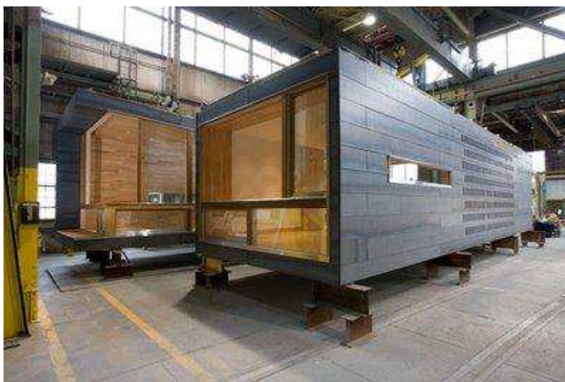
Figura 6 - Unidade modular em fábrica
