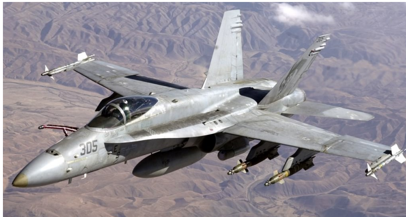
Figura 2.7 – F-18 – Sofreu problemas de não linearidades aeroelásticas gerando LCO. (Fonte: Site Aircraft Recognition, 2017 6 )
