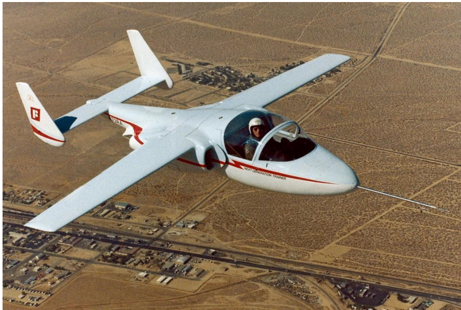
Figura 2.8 –T-46A sofreu em seu teste de voo um flutter no aileron. (Fonte: FRENCH et al , 1987).
