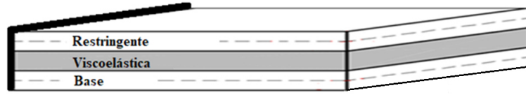
Figura 4.1 – Exemplo de um sistema viscoelástico (adaptado de Lima et al. (2015)).
