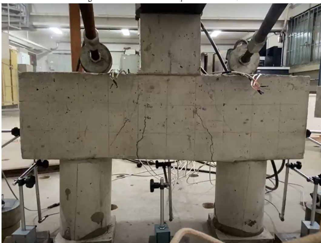
Figura C.4 – Padrão de fissuração bloco BMA202
