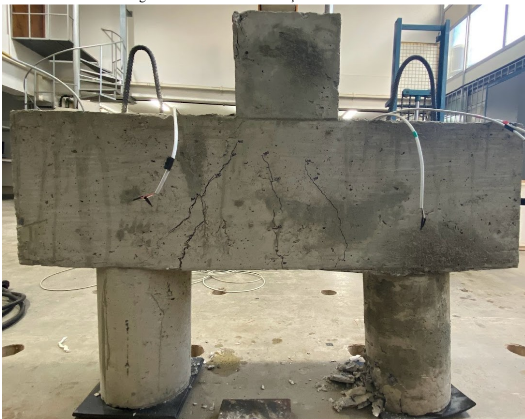
Figura C.5 – Padrão de fissuração bloco BF20A101
