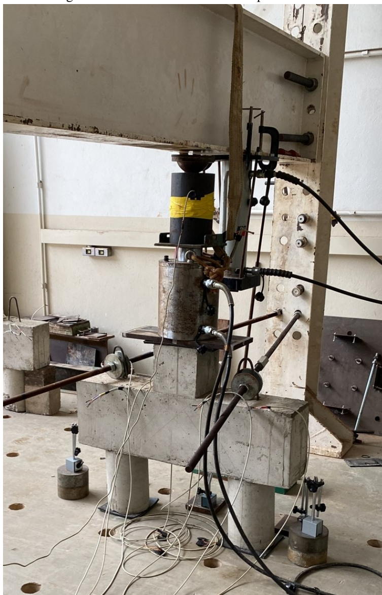
Figura 55 – Estrutura do ensaio de ruptura do bloco
