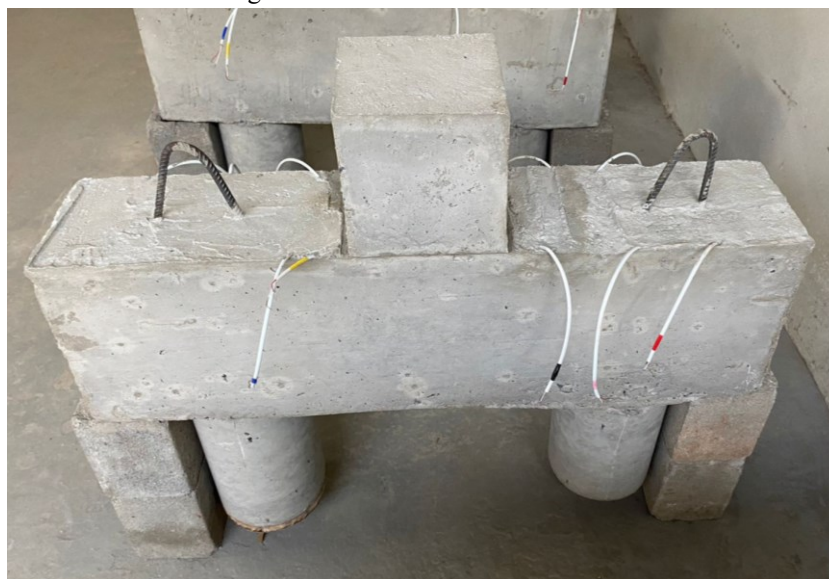
Figura 44 – Bloco sobre duas estacas
