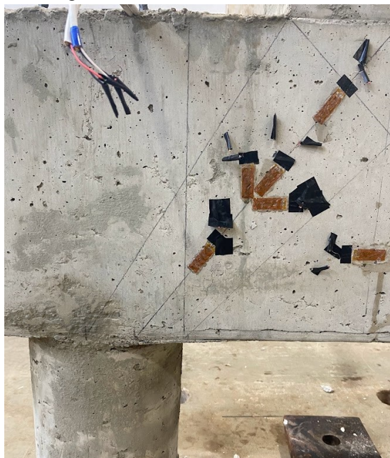
Figura 54 – Extensômetros de concreto
