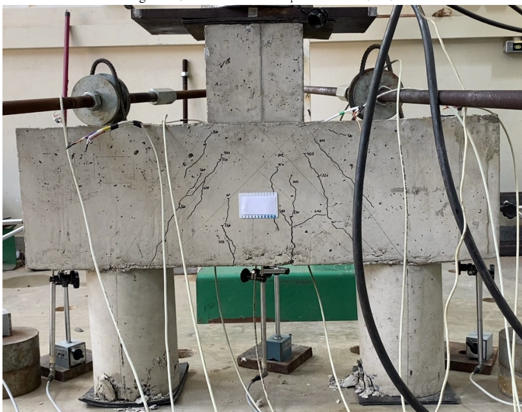
Figura C.8 – Padrão de fissuração bloco BF20A202
