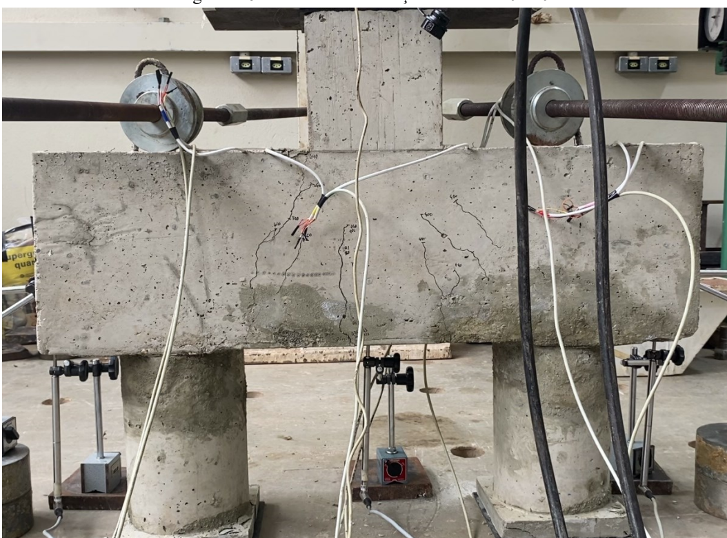
Figura C.6 – Padrão de fissuração bloco BF20A102
