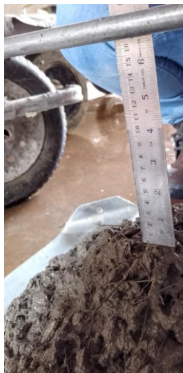
Figura 58 – Abatimento do tronco cone ( slump test )
