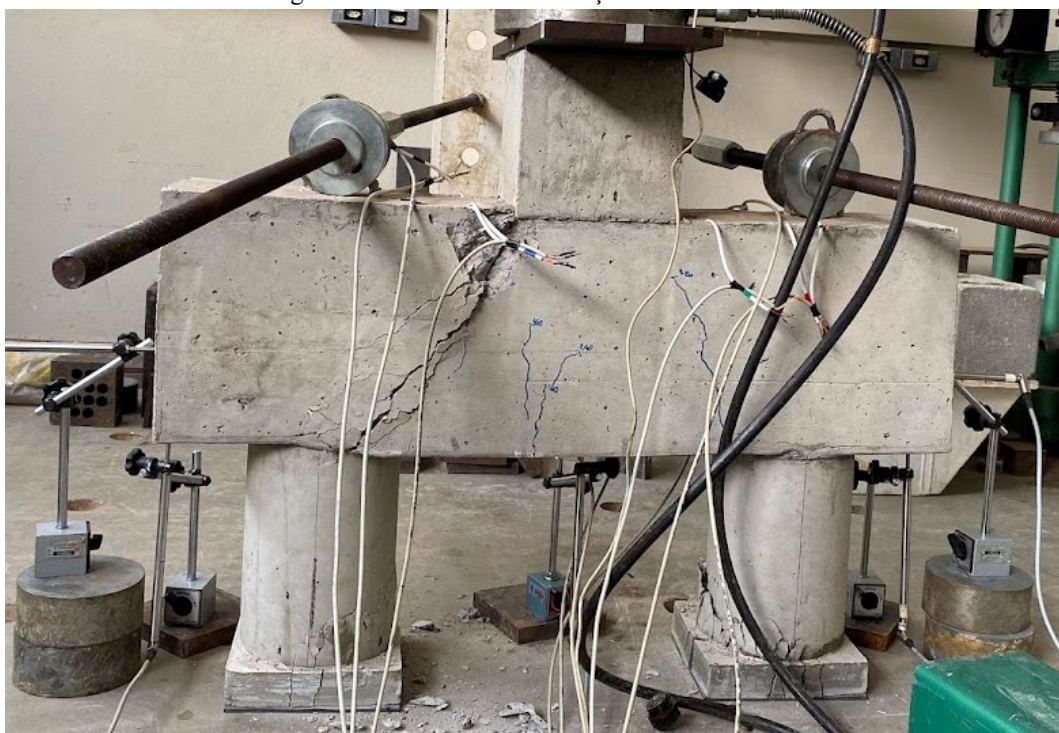
Figura C.3 – Padrão de fissuração bloco BMA201
