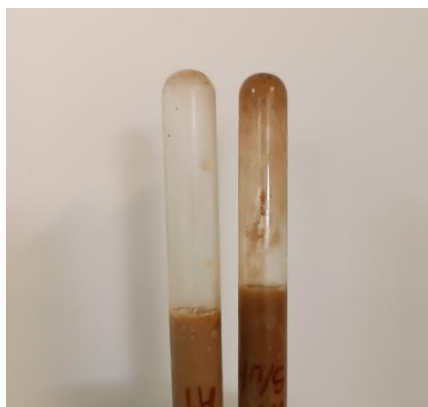
Figura 8: Formação de gel de EPUS (tubo esquerdo) e de EPALC (tubo direito).
