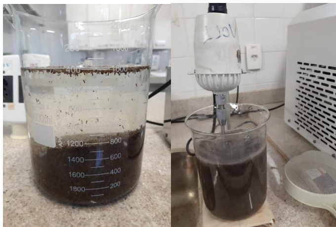
Figura 2: Farinha de GA sendo desengordurada com álcool etílico 99,5% por agitação mecânica
