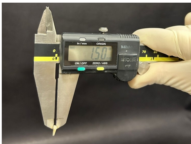
Figura 1. Medição da espessura 1,5mm dos discos de dentina com auxílio de um paquímetro digital.
