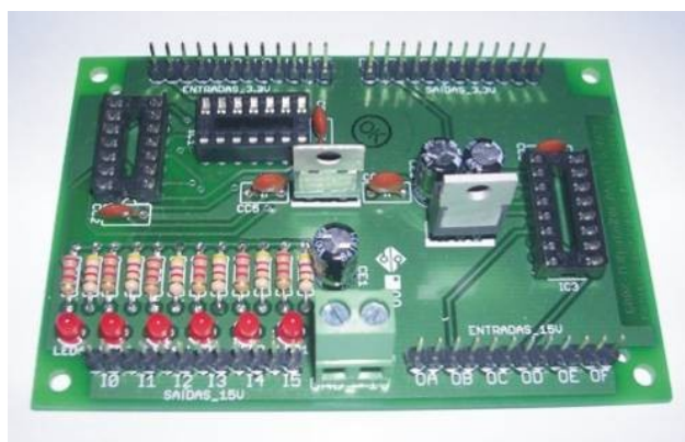
Fig. 5. 18 - Placa de conversão de 3,3 V para 15 V.
