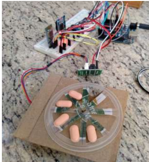
Figura 12 - Detalhe dos componentes eletrônicos montados, sem a caixa
