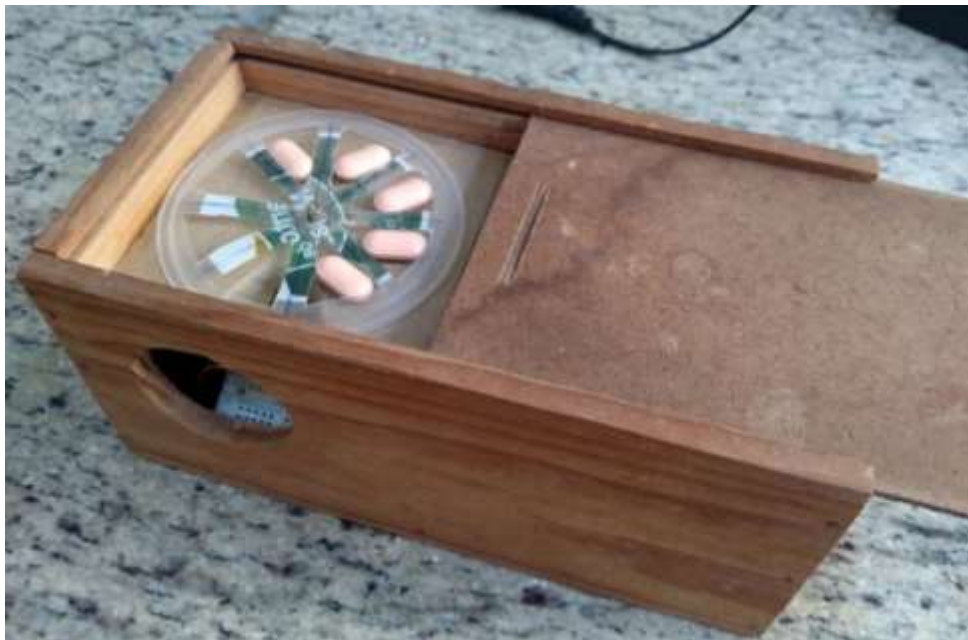
Figura 13 - Dispositivo montado, vista externa com detalhe dos compartimentos para os medicamentos.
