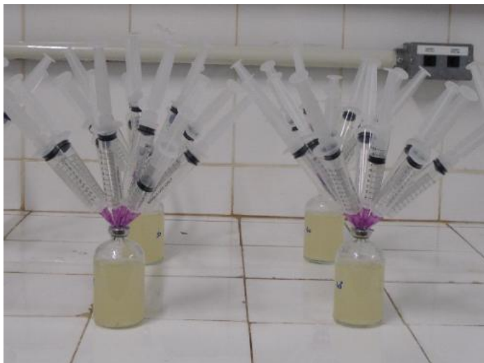
Figura 4.3 – Reator utilizado para a produção de hidrogênio.
