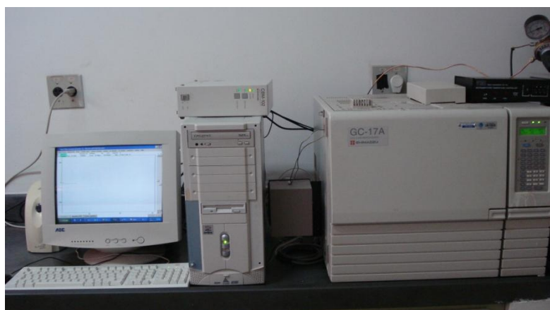
Figura 4.6 – Cromatógrafo utilizado para análise do biogás formado.
