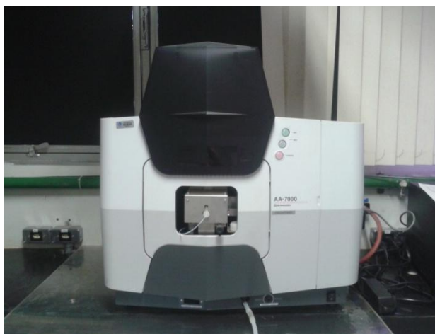
Figura 4.8 – Espectro de absorção atômica utilizado para realizar a quantificação do íon ferro.
