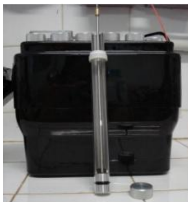
Figura 4.4 – Ampolas gasométricas utilizadas para armazenar o biogás produzido.
