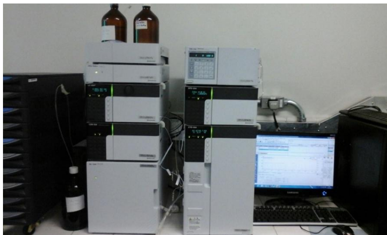
Figura 4.7 – Cromatógrafo utilizado na análise dos metabolitos formados e na quantificação do substrato.
